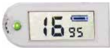
Figura 4. Pantalla LCD que muestra una medición de PIO de 16 y un indicador de confianza estadística de 95
