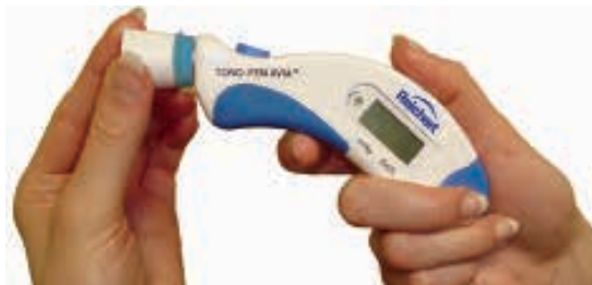
Figura 3. Preparación del tonómetro Tono-Pen AVIA
