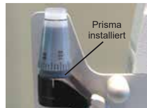
Abbildung IU-01 Prisma installiert
