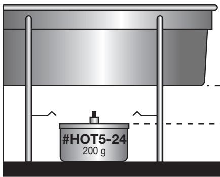
Il est très important de bien positionner le contenant Hot 5™ sous le plat-réchaud pour obtenir un pouvoir calorifique maximal.
